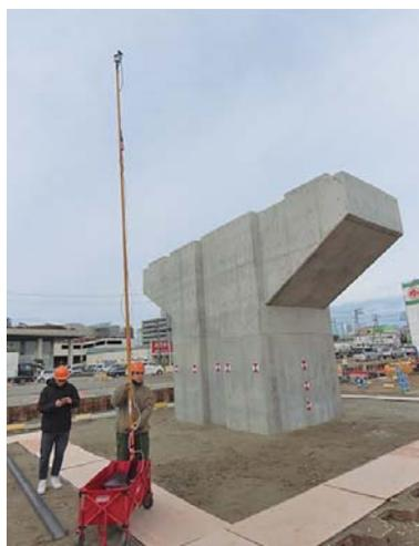
法政大学デザイン工学部都市環境デザイン工学科の今井龍一教授が主宰する社会空間情報研究室と、トップライズ(新潟市、大滝充司社長)は、自己位置の推定と、周囲環境の把握(環境地図作成)を同時に行つSLAM技術を活用し、出来形計測時に死角となる橋脚天端部の3次元データを簡易かつ効率的に取得するシステムを構築した。廉価なLiDAR(レーザー式測距装置)を中心とした既製品で構成されており、補備測量の分野ではコスト、作業性の観点から高い将来性が見込まれる。加賀田組が施工する国土交通省直轄工事で実証実験を進めており、工事現場への適用は全国初となる。
