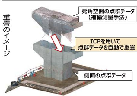
と、自動運転などで導入されているSLAMに着目。LiDARとウェブカメラが一体化したものを、交通量調査で使用する長尺ポールの先端部に設置し、アウトドア用の台車に搭載することで具体化した。さらに出来形管理だけでなく、(死角がある)社会
